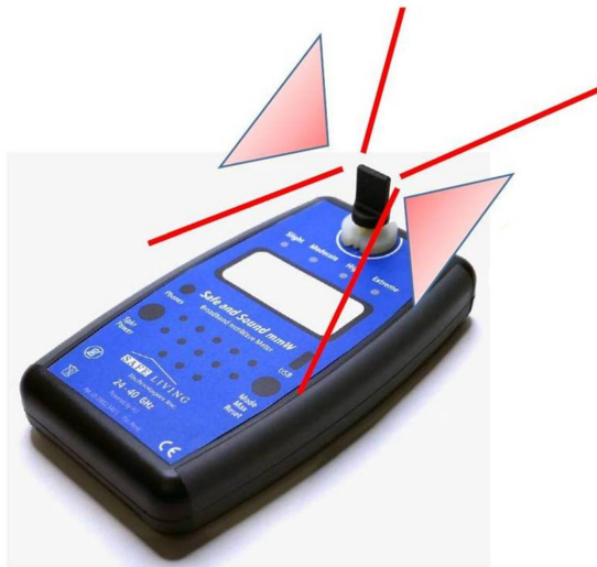
Κεραία τύπου "Stub"- Ημι-Πανκατευθυντική (κάλυψη 50° εμπρός και 50° πίσω)
